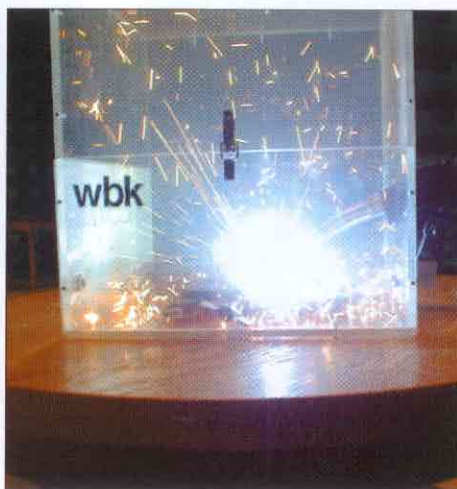
Bild1 : Anlagenaufbau in der Absorberhalle und abgeschirmter Lichtbogen
