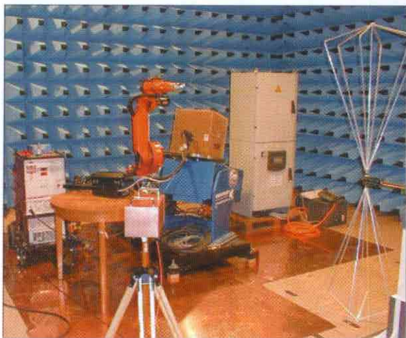
Bild1 : Anlagenaufbau in der Absorberhalle und abgeschirmter Lichtbogen
